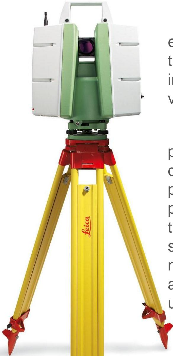
A rede de usuários de laser scanners (HDS) está lentamente aderindo a ideia de utilizar esse tipo de equipamento também como um instrumento topográfico. As vantagens, como veremos, são inúmeras.
